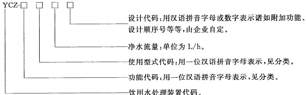
举例:YCZ-KZ3-801, YCZ 表示饮用水处理装置; K 表示矿化水机(器), Z 表示饮水机专用净水机(器); 3 表示净水流量为 3 L/h; 801 表示制造商设计顺序号。
